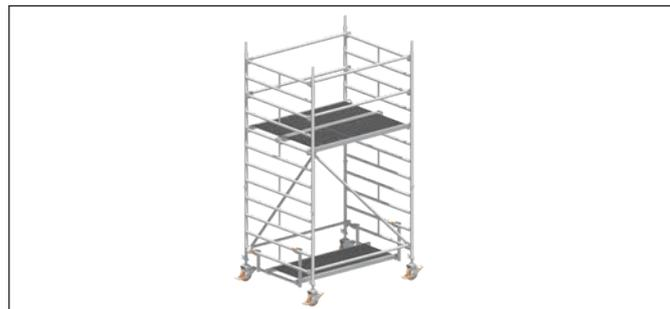
1. Die Lenkrollen **1** werden in die 1,00-m-Standleitern **26** eingesteckt und durch Festdrehen der Flügelschrauben an den Spindelmuttern gegen Herausfallen gesichert.
