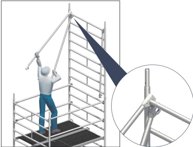
7. Demontage der Geländer **15** durch öffnen der Einrastklaue mithilfe von einem der unter 3. demontierten Zwischengeländer. Das lose Geländer **12** wird auf die 2. Sprosse von oben aufgelegt und wirkt als Hebel zum Öffnen des Schließbügels der Einrastklaue (siehe Detail).
