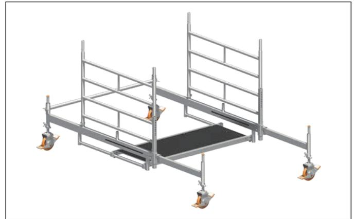
1. Die Lenkrollen **1** in die Fahrbalken **8** einstecken und durch Festdrehen der Flügelschrauben an den Spindelmuttern gegen Herausfallen sichern.
