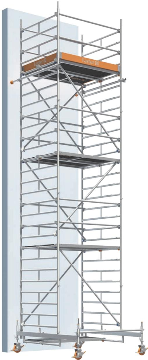
Für Arbeiten, die an einer tragfähigen Wand ausgeführt werden, kann die Ballastierung entsprechend der Tabelle **Ballastierung** (siehe Seite 10) reduziert werden. In diesem Fall sind auf beiden Seiten des Gerüsts Wandabstützungen oder Verankerungen einzubauen.
