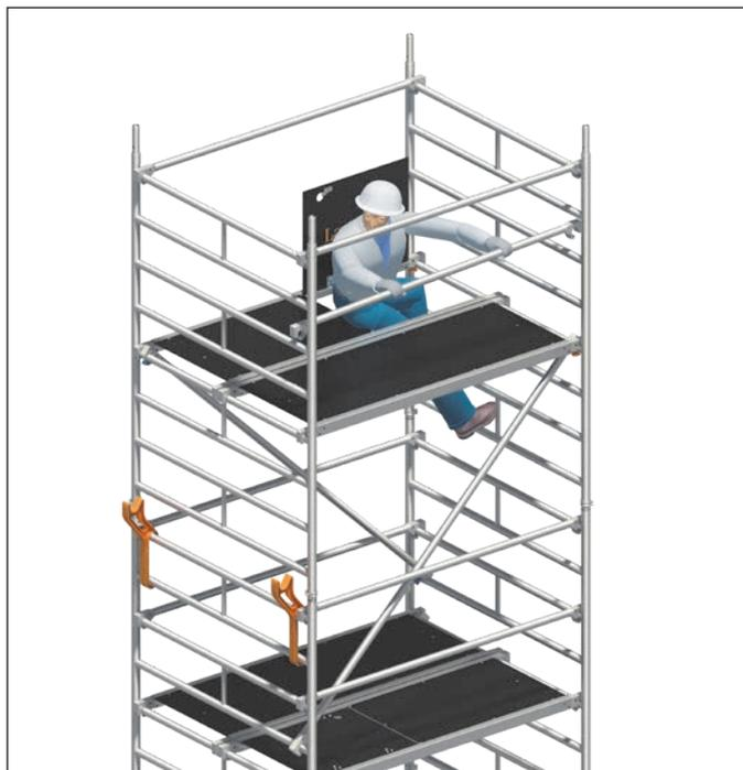
2. In der Durchstiegöffnung sitzend, absturzgesichert durch die Holme der Durchstiegsbrücke **23**, erfolgt die Demontage der Zwischengeländer der jeweiligen Lage, hierzu werden die Geländer **12** an den zweiten Sprossen über der Standfläche demontiert. Sollten die Einrastklauen der Geländer **12** aus der sitzenden Position in der Durchstiegöffnung nicht erreichbar sein, erfolgt die Demontage wie unter **3a** (Seite 18) beschrieben.
