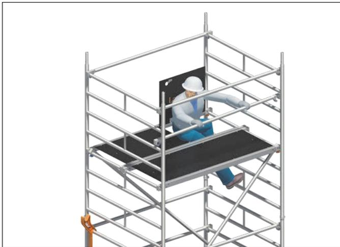
5. Innenseitiger Aufstieg über die Sprossen der Standleiter durch die dafür vorgesehene Durchstiegsklappe. In der Durchstiegöffnung sitzend, absturzesichert durch die Holme der Durchstiegsbrücke **23**, erfolgt die Montage des Zwischengländers der nächsten Lage, hierzu werden die Geländer **12** an den zweiten Sprossen über der Standfläche montiert.
