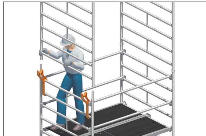
3. Durchstiegsbrücke **23** und Diagonalen **16** demontieren.
