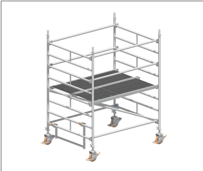
1. Die Lenkrollen **1** werden in die 2,00-m-Standleitern **25** eingesteckt und durch Festdrehen der Flügelschrauben an den Spindelmuttern gegen Herausfallen gesichert.
